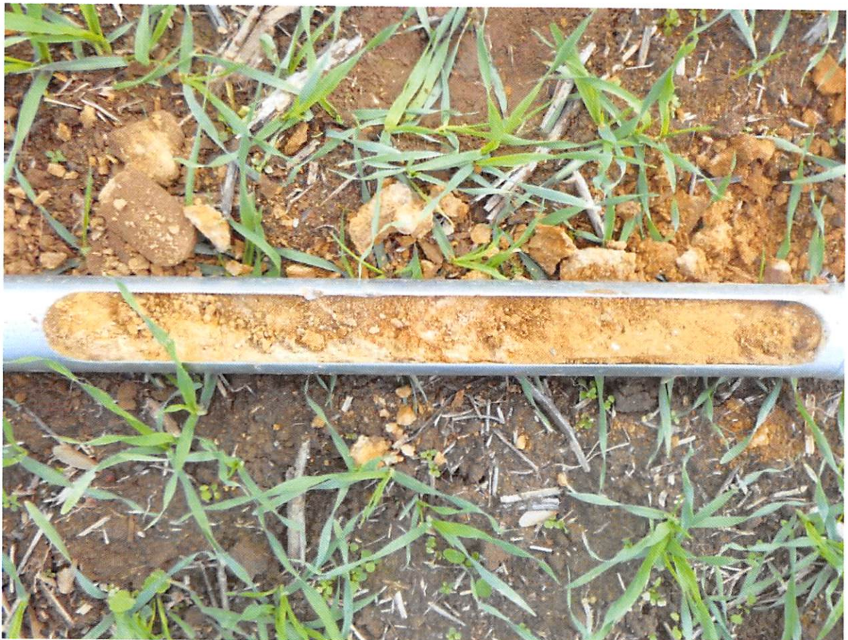
Bild 4: Bohrung 1, Schluff, feinsandig, bis 0,6 m, dann Schluff, stark sandig, kiesig.
