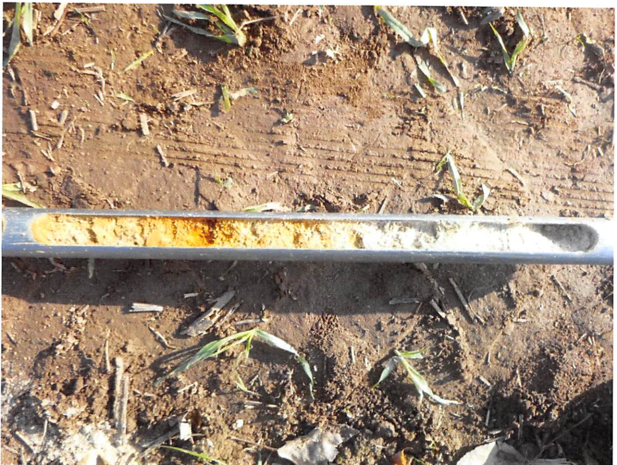
Bild 6: Bohrung 2, Feinsand, schwach schluffig, bei 2,5-3,0 m.
