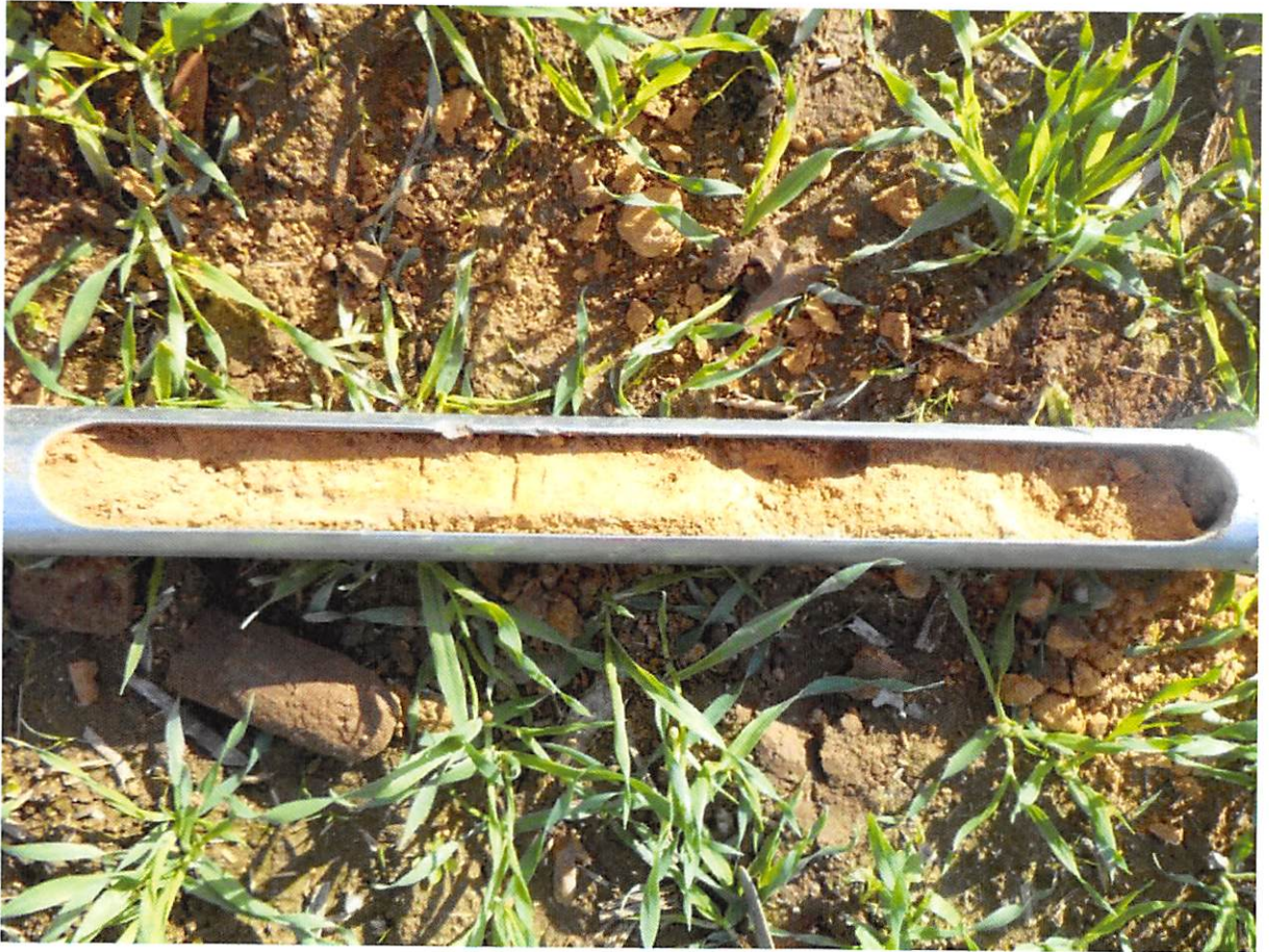
Bild 5: Bohrung 3, Schluff, feinsandig, bis 0,9 m, dann Feinsand, schwach kiesig.
